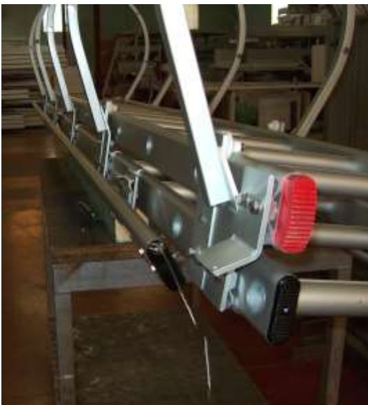
Fig. 6. Bevestiging van de geleiders.
